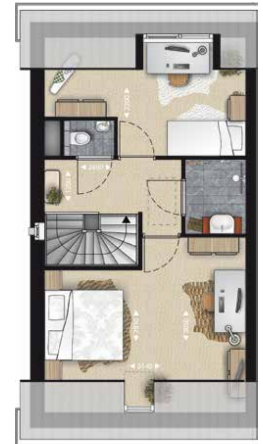
variatie zolderindeling (getoonde opties: extra badkamer en toilet, indeling zolder en dakkapel)
