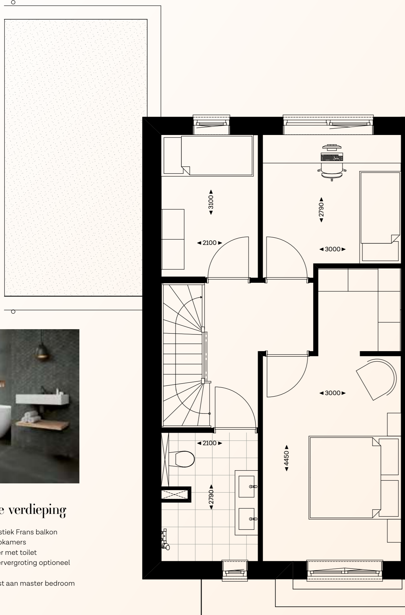
EERSTE VERDIEPING, KAVELS 7 EN 15 (KAVELS 6 EN 14 GESPIEGELD) SCHAAL 1:50
